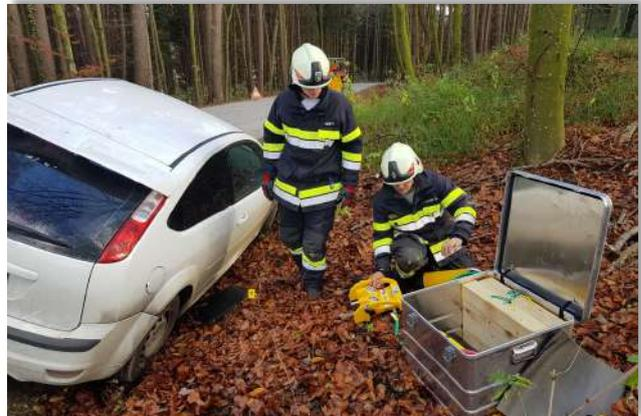
30. November: Ein PKW kam von der Fahrbahn ab und blieb im Straßengraben hängen. Das Fahrzeug wurde mittels Seilwinde, sowie unter Einsatz von Hebekissen geborgen und dem Besitzer übergeben.
